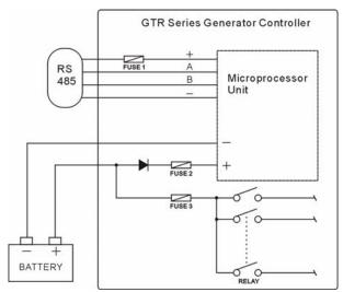
Fuse1: 100 mA Fuse2: 750 mA Fuse3: 6 A
